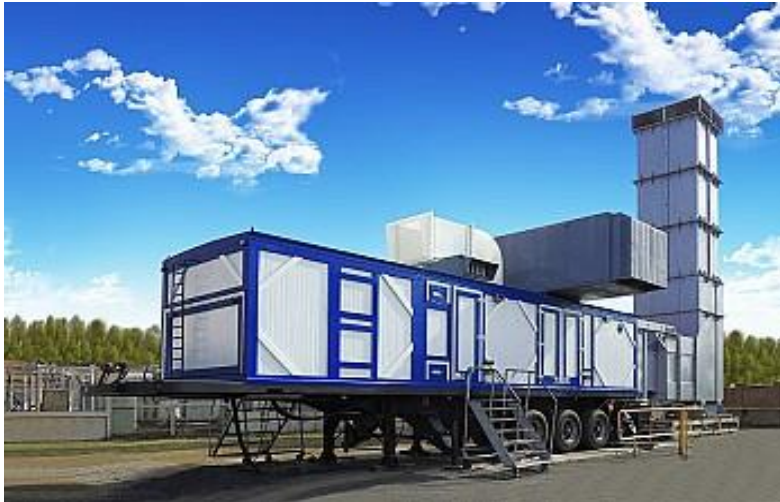
Рис.3 Газотурбинная электростанция «ПАЭС 2500» на месте эксплуатации
